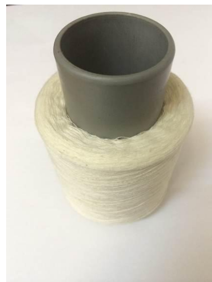
Рисунок 1.7. Образование неравномерной плотности, как по оси, так и по радиусу намотки
