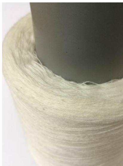
Рисунок 1. 4. Снижение натяжения нити во внутренних слоях полностью наработанной паковке
