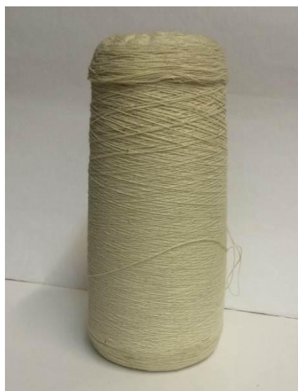
Рисунок 1.7. Образование неравномерной плотности, как по оси, так и по радиусу намотки
