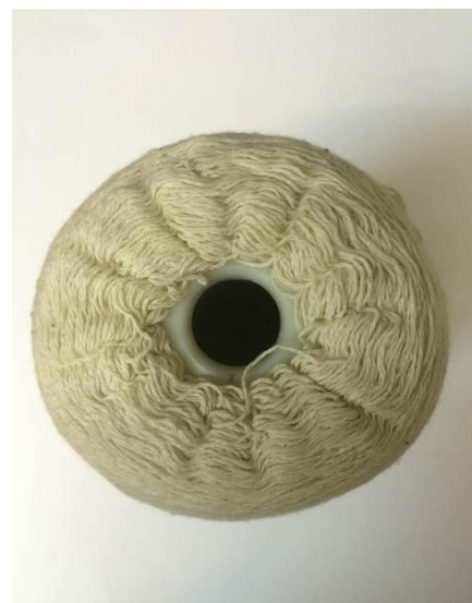
Рисунок 1. 4. Снижение натяжения нити во внутренних слоях полностью наработанной паковке
