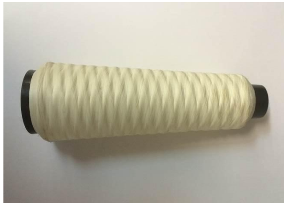
Рисунок 1.6. Образование уплотненных слоев по всей длине паковки (ленточная и жгутовая намотка)
