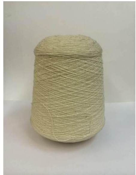
Рисунок 1.5. Выпирающие внутренние слои на свободных торцах паковки
