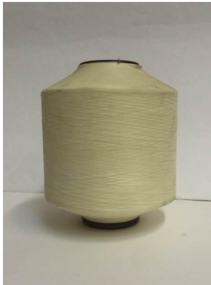
Рисунок 1.5. Выпирающие внутренние слои на свободных торцах паковки
